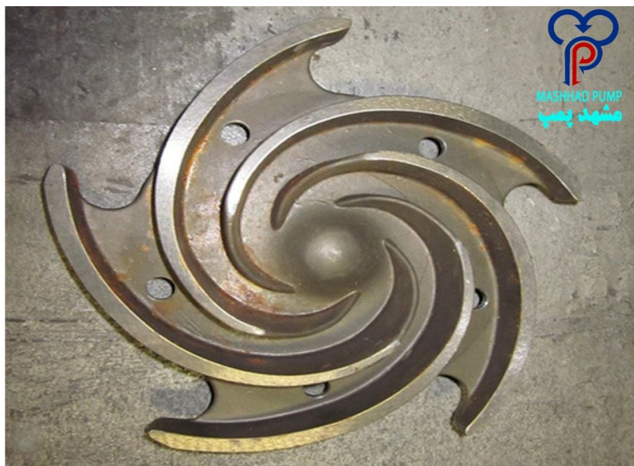
تصویر ۱۲- پروانه نیمه باز با حفره های توازن
