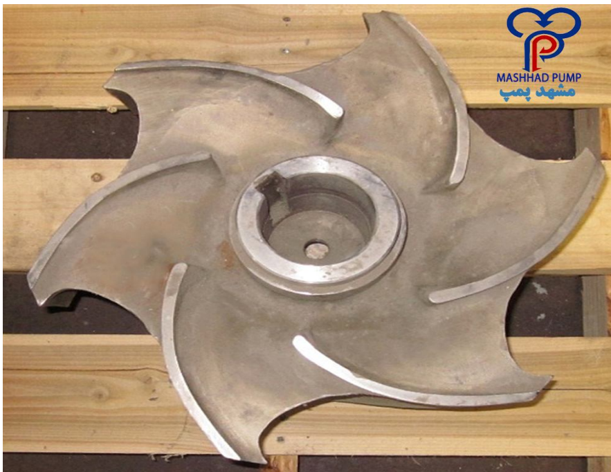
تصویر ۱۳- پروانه با پره های پمپ به بیرون پستی
