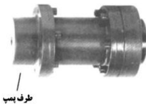
شکل ۳- کوپلینگ قابل انعطاف با قطعه واسطه
