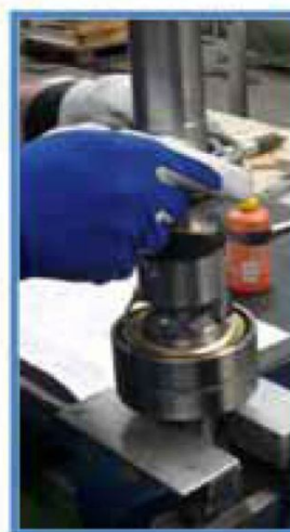
تصویر ۸.۱۱. قرار دادن رینگ های روغن و بلب‌رینگ توپی شعاعی
