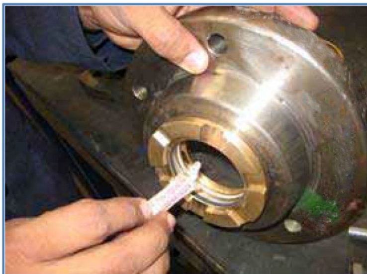
تصویر ۸.۲۸. روغن کاری داخلی رینگ عایق مارپیچی
