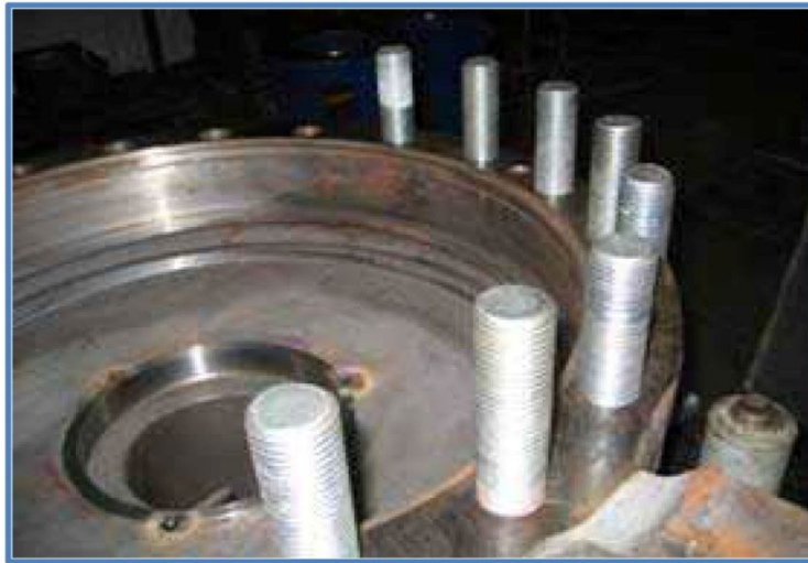
تصویر ۸.۴۹. قرار دادن دستی پیچ های سنتربرد
