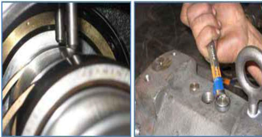
تصویر ۸.۳۱. قرار دادن رینگ های روغن در گیره ها
