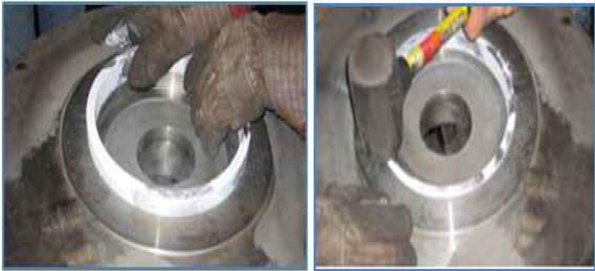
تصویر ۸.۳۷. قرار دادن رینگ سایش
