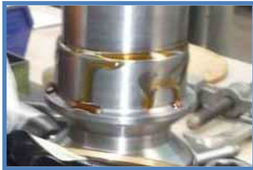
تصویر ۸.۱۰. روغن کاری محور
