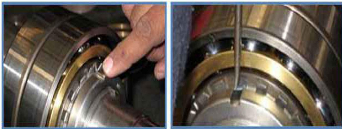
تصویر ۸.۷. خم کردن باریکه فلزی واشر پشت گیر به مهره قفل شو
