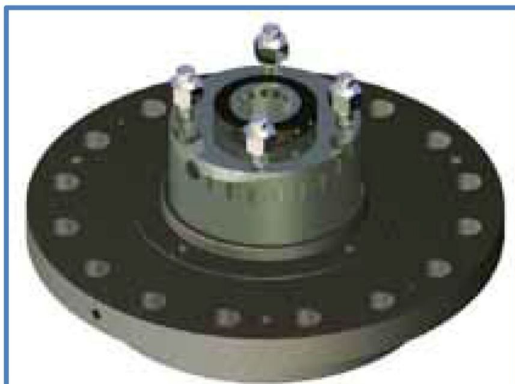
تصویر ۸.۴۳. قرار دادن عایق مکانیکی در قسمت درپوش محفظه پمپ
