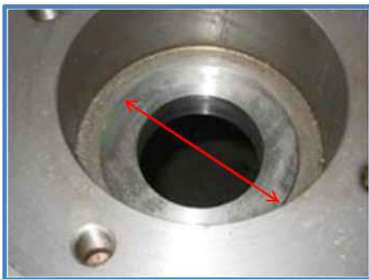
تصویر ۸.۳۶. قرار دادن رینگ سایشی در حفره با موقعیت ۱۸۰ درجه
