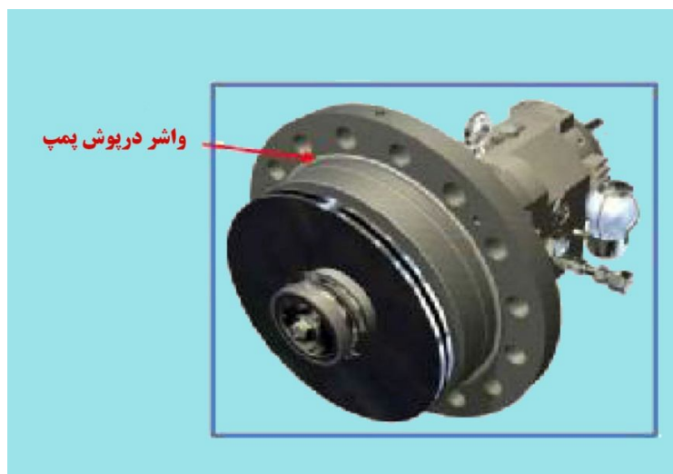
تصویر ۸.۵۲. شناسایی واشر درپوش پمپ
