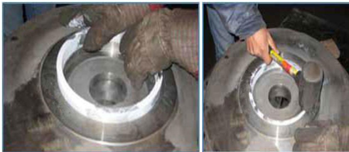
تصویر ۸.۳۳. قرار دادن رینگ سایش
