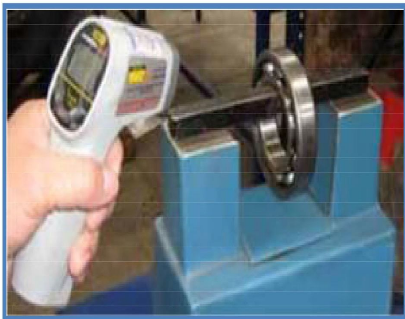
تصویر ۸.۸. حرارت دهی بلبرینگ توپی شعاعی
