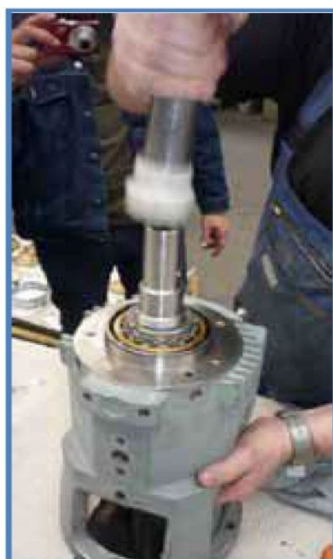
تصویر ۸.۲۵. ضربه زدن نرم به جانب جفت سازی محور
