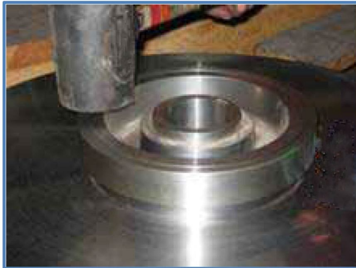
تصویر ۸.۴۰. قرار دادن رینگ های سایش پروانه
