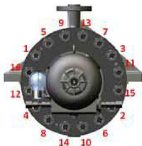
قرار دادن مهره ها و سفت کردن در جهت گردش عقربه ساعت
