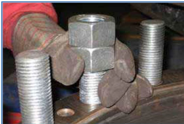
تصویر ۸.۵۰. سفت کردن پیچ های سنتربرد
