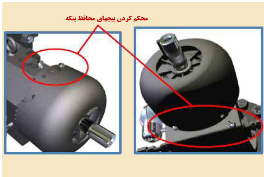
تصویر ۸.۵۶. قرار دادن و سفت کردن پیچ های محافظ پنکه
