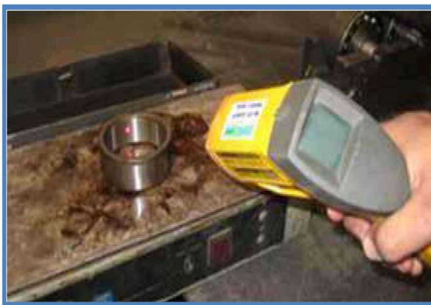
تصویر ۸.۹. گرم کردن جدار داخلی بلبرینگ غلطکی شعاعی
